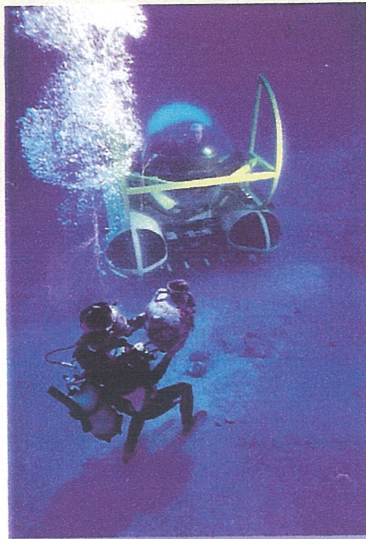
Carolyn denizaltısı en fazla 50 metre denize dabalabilen şeffaf bir küre. Araç tam bir su üstü şartları ve basıncı sağladığından son derece güvenilir ve kullanmak için dalgıç olmak gerekmiyor.
