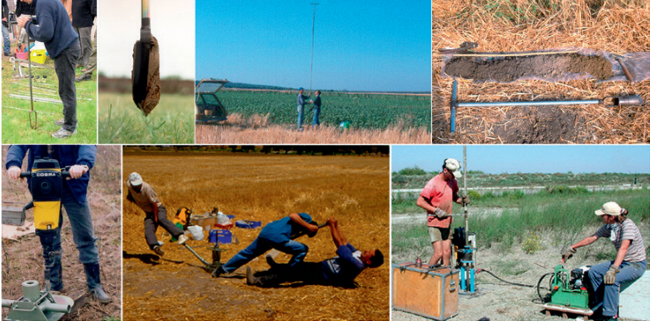
Fig. 2: Eijkelkamp el burgusu sondaj takımı (üstte) ve benzin motorlu vurma başlıklı Atlas Copco Cobra modelleri ile yapılan delgi sondaj çalışmaları.
