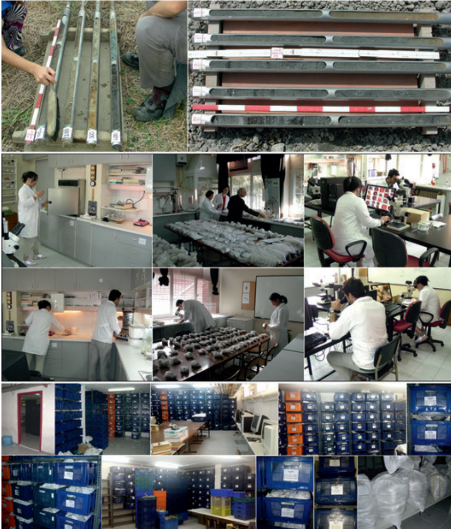
Fig. 3: Delgi sondajlarla araziden alınan sediman örnekleri ve bunların Alüvyal Jeomorfoloji laboratuvarında tane boyu, kimyasal, paleontolojik ve palinolojik analizleri ile bu örneklerin sistematik olarak korundukları depo laboratuvarımızdan görünümür.
