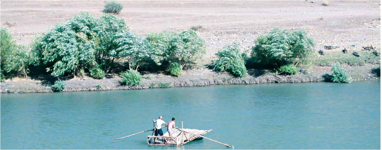
Fig 12: Günümüzde kullanılan, otomobil iç lastiklerinden yapılmış kelek. (Fotoğraf: Haluk Sağlamtimur)
