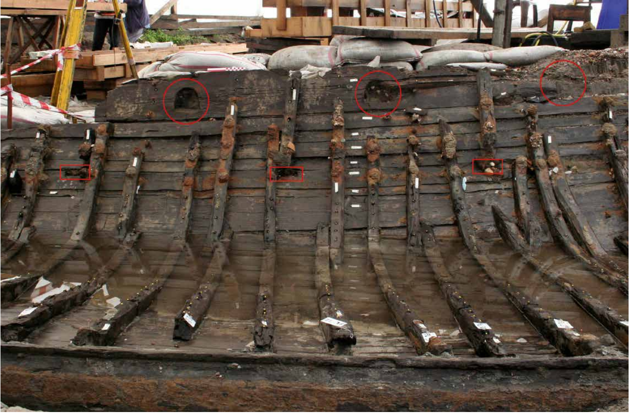
İstanbul Yenikapı'dan çıkarılan YK4 kalyonunun kürek delikleri ve oturak yuvaları. (© INA fotoğraf: M. Jones) The oarports and bench notches of galley YK4 from Yenikapı, Istanbul. (© INA photo by M. Jones)
